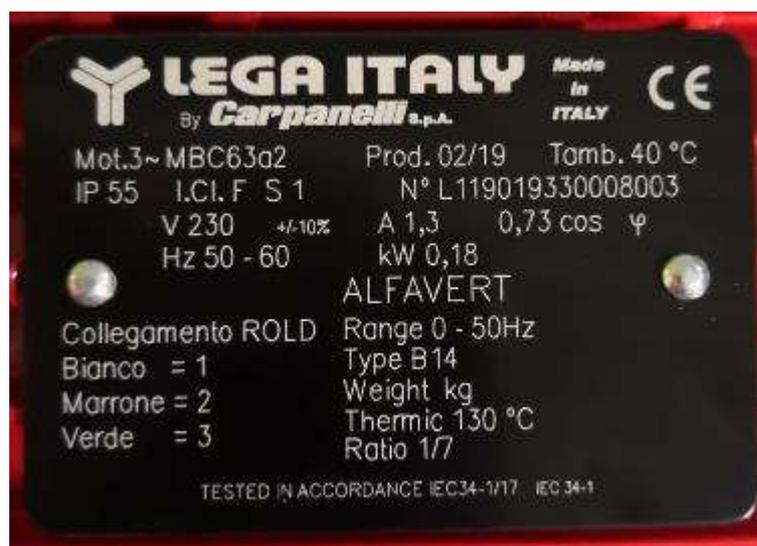
La targhetta coi dati del motore è fissata nella parte inferiore del motore.
