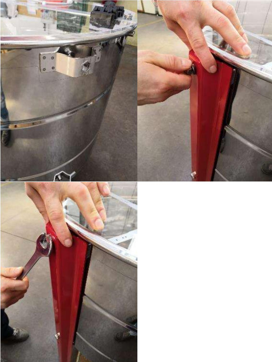
Nous conseillons de placer les tampons en feutrine au moment du montage des pieds sur l'extracteur. Cela permettra une réduction des vibrations de l'extracteur en phase de fonctionnement.
