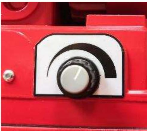
Au bout de quelques secondes, la cage commencera à tourner, en parcourant une rampe d'accélération contrôlée, jusqu'à atteindre la vitesse sélectionnée ;
