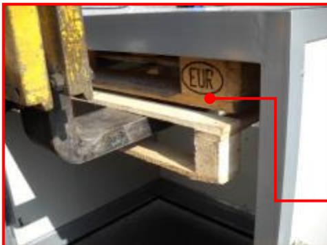
Durch Entfernen der vorderen Tür ist es möglich, die Struktur anzuheben, indem die Gabeln eines Gabelstaplers auf der Innenseite der Decke platziert werden. Achten Sie in diesem Fall darauf, die Teile in der Kammer nicht zu beschädigen.
