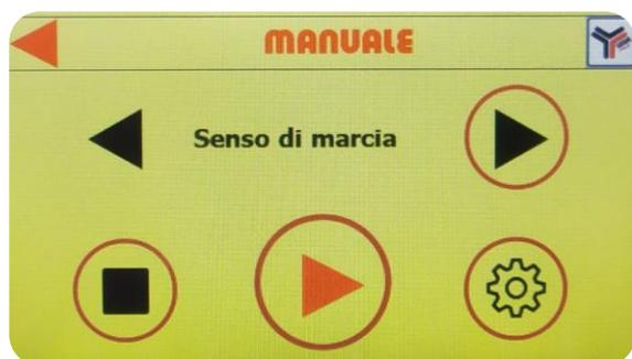
Impostare la velocità di rotazione a seconda della tipologia di miele. Maggiore sarà la durezza del miele, minore dovrà essere la velocità della pompa
